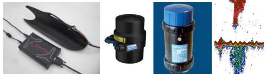
Sonar de barrido lateral (SSS), modem acústico, sonda monohaz escaneada mecánicamente (SBE), imagen del ECO-PAMPA, de izquierda a derecha.
